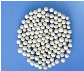
新型IPA吸附濾材 (孔洞設計、表面親疏水性)
